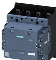
Contattore, AC-1, 200 A/400 V/40 °C, S6, a 4 poli, AC/DC 100 ... 250 V, 2NO+2NC, sbarra di collegamento/ morsetti a vite
